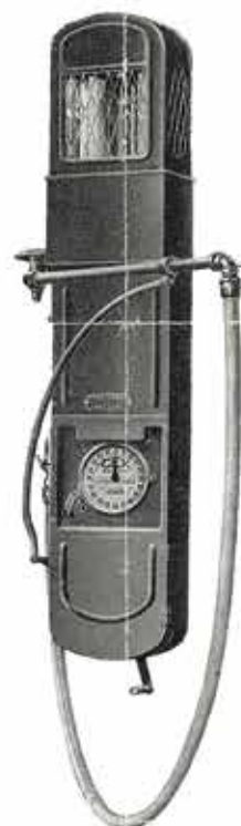
Arch. dép. AHP, 5 M 16 Distributeur d'essence mural, utilisé par l'entrepreneur en transport automobile Astier de Barcelonnette, 1937
